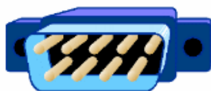
Figura 3.5. Conectorul DB-9 utilizat pentru porturile seriale ale calculatoarelor IBM PC.
