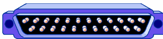
Figura 3.4. Conectorul DB-25 utilizat pentru porturile seriale ale calculatoarelor IBM PC din generațiile anterioare.
